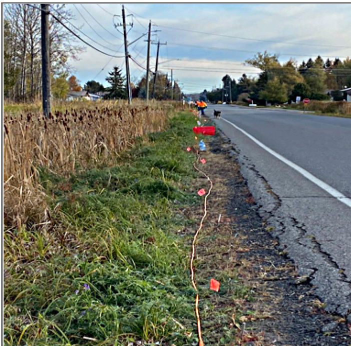
Figura 4: Cable de 400 metros del tendido eléctrico. Junto a la banderola se puede apreciar el electrodo clavado en el suelo que se conecta cada 5 metros
