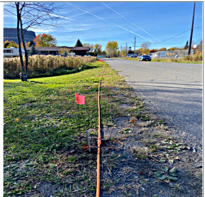
Figura 4: Cable de 400 metros del tendido eléctrico. Junto a la banderola se puede apreciar el electrodo clavado en el suelo que se conecta cada 5 metros
